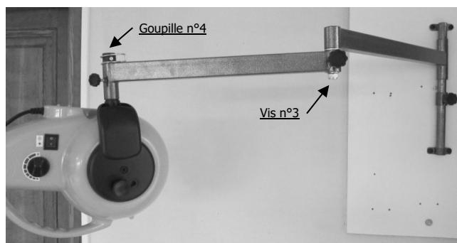
Placer et serrer légèrement une des vis n°3 à l'extrémité du bras mural (côté pulseur), la vis n°3 devra être placée au point de pivot du bras. Placer le dispositif séchant (à l'aide de l'adaptateur fourni) et le bloquer à l'aide de la goupille n°4.
